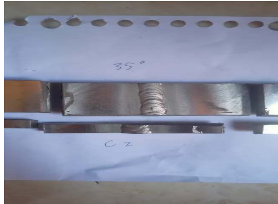
Gambar 8. Spesimen C2 (HF 3%; 35°C) setelah proses pickling
