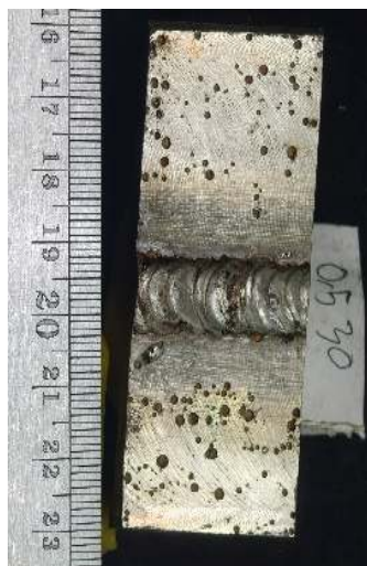
Gambar 13–14. Permukaan spesimen setelah uji ASTM G48: (kiri) A1 — densitas 196.161,12 pit/m 2 ; (kanan) C3 — densitas 117.270,79 pit/m 2
