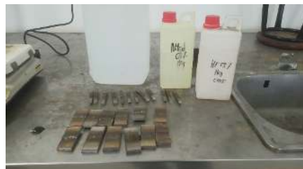
Gambar 4. Spesimen las dan larutan \text{HNO}_3 /HF yang digunakan pada proses pickling
