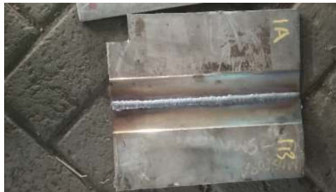
Gambar 7. Heat tint pada permukaan sambungan las GTAW sebelum proses pickling
