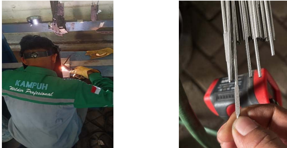
Gambar 3. (a) Proses pengelasan GTAW spesimen uji; (b) filler metal ER308L yang digunakan
