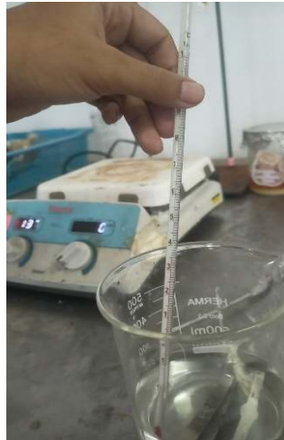
Gambar 5. Pengontrolan temperatur larutan pickling menggunakan hot plate dan thermometer
